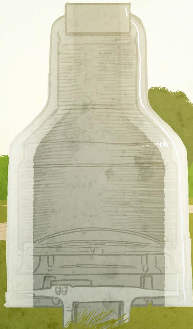
Auf Kaltehofe wurde ein Meßgerät zur Berechnung von Niederschlagsmengen aufgestellt. **Das Regenwasser wird** über die Öffnung, durch die man oben in den Auffanghalter hineinschauen kann, aufgefangen und **in dem Behälter gewogen.**
